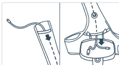
Faites passer le câble en Y dans le holster. L'extrémité double vers le bas et l'extrémité simple vers le haut.
